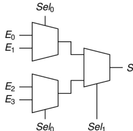
Peut être réalisé à partir de 3 mux 2 vers 1
