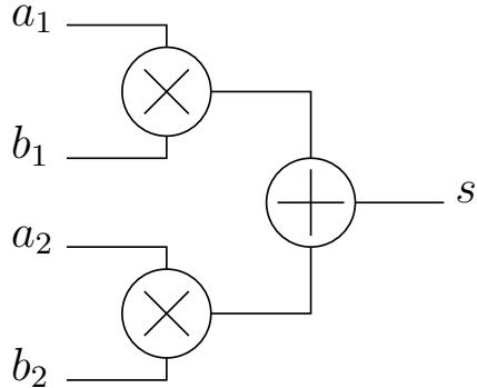
**Question 1 :** Les entrées sont des nombres positifs codés sur 4 bits en virgule fixe : 2 bits pour la partie entière et 2 bits pour la partie fractionnaire. Les calculs se font avec la précision maximale.
